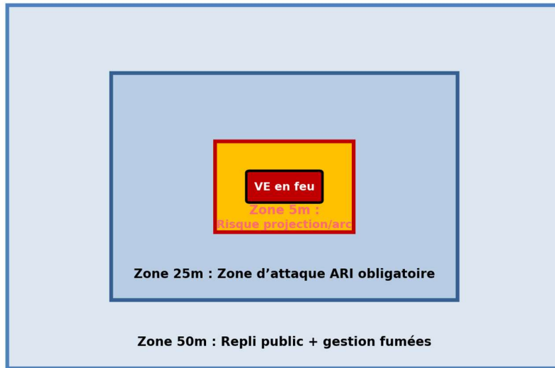
Figure 5 - Périmètre indicatif issu d'un RETEX : zones 5 m, 25 m et 50 m à adapter selon configuration.
