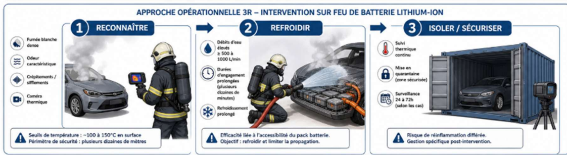
Figure 1 : Schéma simplifié d'intervention sur feu de batterie lithium-ion – approche "Reconnaître / Refroidir / Isoler" (illustration pédagogique issue de RETEX).
