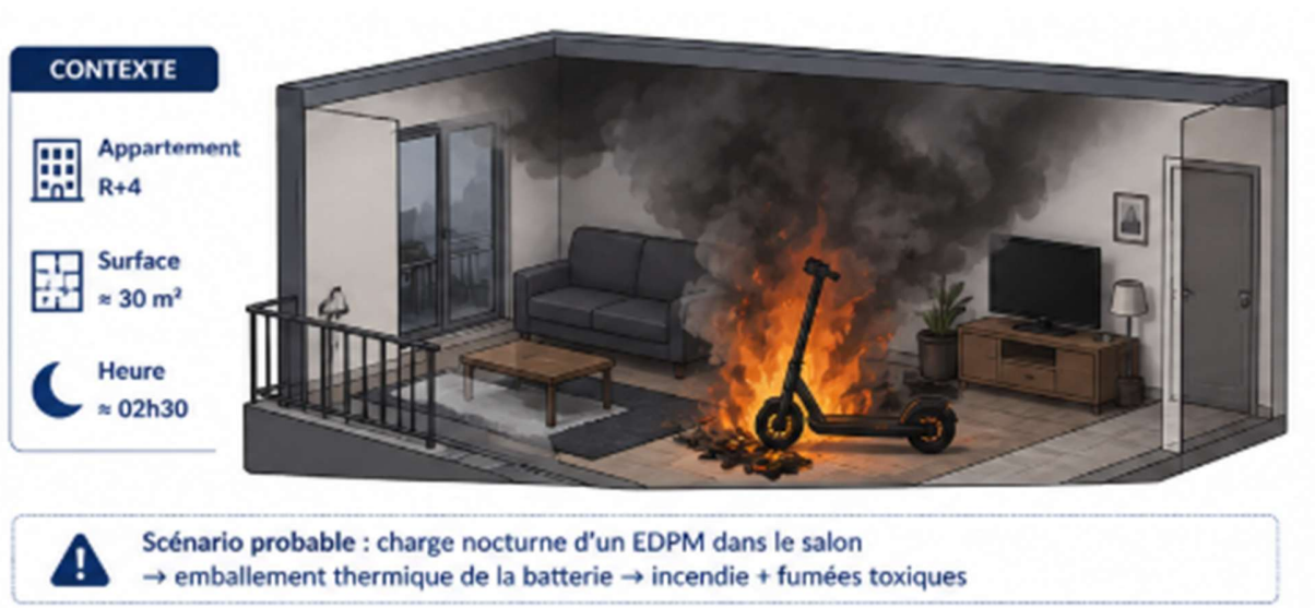
Figure 6 - Scénario EDPM en appartement : charge nocturne, emballement thermique, fumées toxiques.
